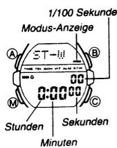
Im Stoppuhr-Modus können die verstrichene Zeit, Zwischenzeiten und die Zeiten von zwei Finalisten gemessen werden. Die Stoppuhr kann Messungen bis zu 23 Stunden, 59 Minuten und 59,99 Sekunden durchführen.
