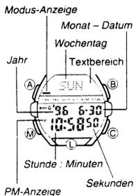
Neben der normalen Zeitanzeige dient der Zeitanzeige-Modus auch zum Einstellen der aktuellen Uhrzeit und des Datums. Darüber hinaus kann jederzeit durch Drücken von zwei Knöpfen die Sekundenzählung auf "00" rückgestellt werden.
