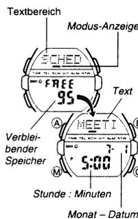
Im Terminplan-Memo-Modus können Sie bis zu 100\* Terminplan-Memo-Datensätze (Datum und Zeit des Termins und Text) speichern. Wenn die eingestellte Zeit erreicht wird, ertönt ein Alarm, und der Text, den Sie für die Daten eingegeben haben, rollt im Textbereich des Displays durch.
