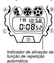
Indicador de ativação da função de repetição automática
