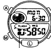
Eine Hintergrundleuchte, die eine elektrolumineszente (EL) Tafel verwendet, beleuchtet das Display, so daß dieses auch im Dunkeln einfach abgelesen werden kann. Eine EL-Alarmfunktion kann eingeschaltet werden, so daß die Hintergrundleuchte blinkt, wenn ein Alarm oder das stündliche Zeitsignal ertönt.
