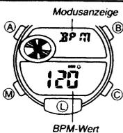
Der Beat-Counter-Modus kann verwendet werden, um ein hörbares Signal in Abhängigkeit von dem BPM-Wert (Beats pro Minute) zu erzeugen, der einem Digital-Metronom entspricht, das für eine Vielzahl verschiedener musikalischer Anwendungen verwendet werden kann.
