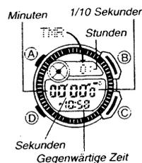
Der Countdown-Timer kann in einem Bereich von 1 Sekunde bis zu 24 Stunden eingestellt werden. Wenn der Countdown Null erreicht, ertönt ein Alarm.
