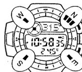
3. Nun können Sie den drehenden Richtungszierring so einstellen, daß die Markierung „N“ oder „▼“ mit dem Zeiger für den magnetischen Norden ausgerichtet ist. Dadurch werden alle Markierungen am Zierring mit den entsprechenden Richtungen ausgerichtet.
