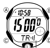
Indicatore di segnalatore acustico di avanzamento attivato
