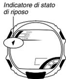
Se l'indicatore di stato di riposo (S/SLEEP) è visualizzato sul display, significa che la visualizzazione sul display è assente perché la funzione di risparmio energetico dell'orologio ha spento il display per conservare energia. La funzione di risparmio energetico fa spegnere automaticamente il display e fa entrare l'orologio in uno stato di riposo ogni volta che l'orologio viene lasciato in un luogo buio per un certo lasso di tempo.
