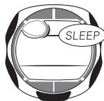
Cuando se encuentra activada, la función de ahorro de energía coloca el reloj en una condición de letargo siempre que se lo deja en un lugar oscuro durante 30 a 35 minutos. La condición de letargo se indica mediante una pantalla en blanco, con SLEEP destellando sobre la misma. En la condición de letargo, todas las funciones se encuentran habilitadas, excepto para la presentación.
