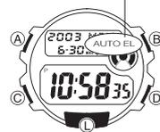
La retroilluminazione impiega un pannello elettroluminescente (EL) che fa illuminare l'intero display per facilitare la visione delle indicazioni al buio. La funzione di illuminazione automatica dell'orologio fa accendere automaticamente la retroilluminazione quando si orienta l'orologio verso il proprio viso.
