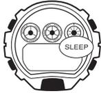
Falls der SLEEP-Indikator am Display angezeigt wird, dann ist das Display leer, da die Stromsparfunktion der Armbanduhr das Display ausgeschaltet hat, um Strom zu sparen. Die Stromsparfunktion schaltet das Display automatisch aus und schaltet die Armbanduhr in den Schlafstatus, wenn Sie Ihre Armbanduhr für eine bestimmte Zeitdauer an einem dunklen Ort belassen.
