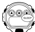
Wenn eingeschaltet, versetzt die Stromsparfunktion die Armbanduhr in den Schlafstatus, wenn sie für 30 bis 35 Minuten an einem dunklen Ort belassen wird. Der Schlafstatus wird durch eine leere Anzeige mit dem blinkenden Schriftzug **SLEEP** angezeigt. In dem Schlafstatus sind alle Funktionen aktiviert, mit Ausnahme des Displays.
