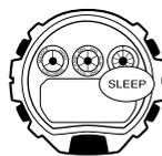
Quando è attivata, la funzione di risparmio energetico pone automaticamente l'orologio in uno stato di riposo ogni volta che l'orologio viene lasciato in un luogo buio per 30 - 35 minuti. Lo stato di riposo è indicato da una schermata vuota con **SLEEP** lampeggiante su di essa. Nello stato di riposo, tutte le funzioni sono abilitate, ad eccezione della visualizzazione.
