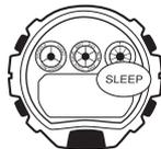
Se l'indicatore **SLEEP** è visualizzato sul display, significa che la visualizzazione sul display è assente perché la funzione di risparmio energetico dell'orologio ha spento il display per conservare energia. La funzione di risparmio energetico fa spegnere automaticamente il display e pone l'orologio in uno stato di riposo ogni volta che l'orologio viene lasciato in un luogo buio per un certo lasso di tempo.
