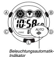
Die Uhr besitzt ein EL (Elektrolumineszenz)-Panel, das zur besseren Ablesbarkeit im Dunkeln das gesamte Display leuchten lässt. Die Beleuchtungsautomatik schaltet die Beleuchtung des Displays automatisch ein, wenn Sie die Uhr in einem bestimmten Winkel auf Ihr Gesicht richten.
