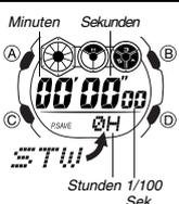
Die Stoppuhr lässt Sie die abgelaufene Zeit, Zwischenzeiten und zwei Endzeiten messen.
