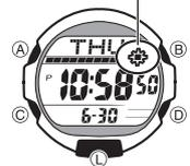
La luz de fondo utiliza un panel EL (electroluminiscente) que ocasiona que la pantalla entera se ilumine para una fácil lectura en la oscuridad. El interruptor de luz automático del reloj activa automáticamente la luz de fondo cuando inclina el reloj hacia su cara.
