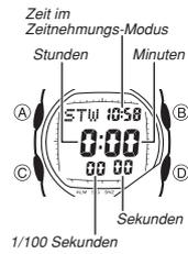
Die Stoppuhr lässt Sie die abgelaufene Zeit, Zwischenzeiten und zwei Endzeiten messen. Sie besitzt darüber hinaus eine Auto-Start-Funktion.
