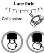
L'elettricità generata dalla cella solare dell'orologio viene accumulata da una pila incorporata. Se si lascia o se si usa l'orologio in luoghi in cui esso non è esposto alla luce, la pila si scarica. Accertarsi che l'orologio sia esposto il più possibile alla luce.
