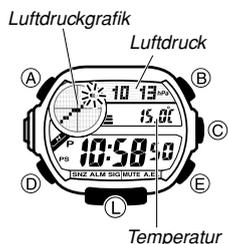
Rufen Sie durch Drücken von Knopf D im Uhrzeitmodus den Barometer/Thermometer-Modus auf. Damit startet automatisch die Messung von Luftdruck und Temperatur.
