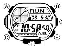
Ein-Indikator für automatischen Beleuchtungsschalter
