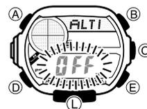
1. Halten Sie im Höhenmessermodus circa zwei Sekunden lang den Knopf (A) gedrückt, bis **OFF** oder der aktuelle Wert der Bezugshöhe zu blinken beginnt. Dies ist die Einstellanzeige.
