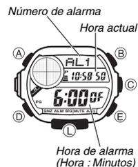
El modo de alarma le permite elegir entre cuatro alarmas que suenan una vez y una alarma con repetición.
