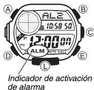
1. En el modo de alarma, utilice **E** y **B** para desplazarse a través de las pantallas, hasta visualizar la alarma cuya hora desea ajustar.
