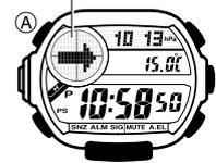
En el modo de barómetro/termómetro, presione el botón (A) para alternar entre el gráfico de presión barométrica y el indicador de cambios de presión barométrica.
