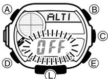
1. En el modo de altímetro, mantenga presionado (A) por unos dos segundos hasta que **OFF** o el valor de altitud de referencia actual comience a parpadear. Esta es la pantalla de ajuste.
