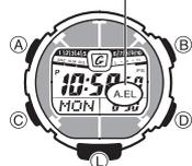
Questo orologio dispone di un pannello elettroluminescente (EL) che fa illuminare l'intero display per facilitare la visione delle indicazioni al buio. La funzione di illuminazione automatica dell'orologio fa accendere automaticamente l'illuminazione quando si orienta l'orologio verso il proprio viso per leggere le indicazioni.
