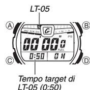
L'orologio dispone di 10 tempi target preselezionati (tempi di collegamento), che possono essere utilizzati così come sono oppure per passare al valore desiderato. È possibile usare il tasto (B) per selezionare il tempo target desiderato mentre il tempo target attuale si trova nello stato di riporto al suo valore iniziale.
