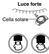
L'elettricità generata dalla cella solare dell'orologio viene accumulata da una pila incorporata. Se si lascia o se si usa l'orologio in luoghi in cui esso non è esposto alla luce, la pila si scarica. Accertarsi che l'orologio sia esposto il più possibile alla luce.
