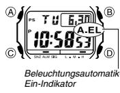
Die Uhr besitzt ein EL (Elektrolumineszenz)-Panel, das zur besseren Ablesbarkeit im Dunkeln das gesamte Display leuchten lässt. Die Beleuchtungsautomatik schaltet die Beleuchtung des Displays automatisch ein, wenn Sie die Uhr in einem bestimmten Winkel auf Ihr Gesicht richten.
