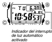
El reloj tiene un panel EL (electroluminiscente) que ilumina la presentación entera para una fácil lectura en la oscuridad. El interruptor de luz automático del reloj ilumina automáticamente la presentación cuando inclina el reloj hacia su cara.
