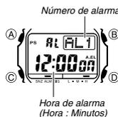
El modo de alarma le permite elegir entre cuatro alarmas sin repetición y una alarma con repetición. También utilice el modo de alarma para activar y desactivar la señal horaria (**Σ I G**).
