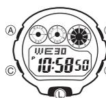
El reloj tiene un panel EL (electroluminiscente) que ocasiona que la presentación entera se ilumine para una fácil lectura en la oscuridad.
