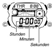
Sie können am Countdown-Timer eine Zeit im Bereich von einer Minute bis 24 Stunden einstellen. Wenn der Countdown Null erreicht, ertönt ein Alarmton.
