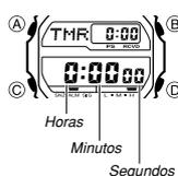
Puede ajustar el temporizador de cuenta regresiva dentro de un rango de 1 minuto a 24 horas. Suena una alarma cuando la cuenta regresiva llega a cero.
