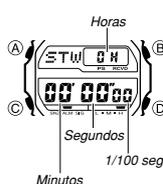
El cronómetro le permite medir el tiempo transcurrido, tiempos fraccionados y dos llegadas a meta.
