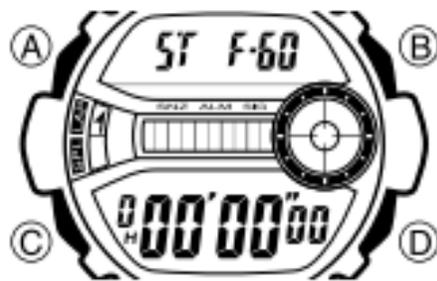
прекратится, и в течение 8 секунд будет отображаться зафиксированное время. Одновременно с этим часы продолжают измерение общего прошедшего времени без его отображения на экране часов. В нижней части экрана отобразится индикатор номера дистанции.
