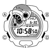
Questo orologio dispone di un pannello elettroluminescente (EL) che fa illuminare l'intero display per facilitare la visione delle indicazioni al buio. La funzione di illuminazione automatica dell'orologio fa accendere automaticamente l'illuminazione quando si orienta l'orologio verso il proprio viso per leggere le indicazioni.
