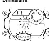
Wenn auf Blinkalarm geschaltet ist, blinkt für Alarme, das stündliche Zeitsignal und den Countdown-Alarm die Beleuchtung.
