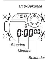
Der Countdown-Timer kann in einem Bereich von einer Sekunde bis zu 24 Stunden eingestellt werden. Ein Alarm ertönt, wenn der Countdown Null erreicht.
