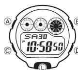
El reloj tiene un panel EL (electroluminiscente) que ocasiona que la presentación entera se ilumine para una fácil lectura en la oscuridad.
