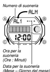
È possibile impostare fino a tre suonerie multifunzione indipendenti con ore, minuti, mese e giorno del mese. Quando una suoneria è attivata, il segnale acustico della suoneria suona quando viene raggiunta l'ora fissata per la suoneria. Una delle suonerie è una suoneria a ripetizione. È possibile attivare anche il segnale orario di ora esatta che fa suonare l'orologio due volte ogni ora allo scoccare dell'ora.
