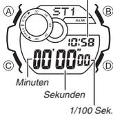
Die Uhr besitzt zwei Stoppuhrmodi: Stoppuhrmodus (ST1) und Stoppuhrmodus (ST2). Mit beiden Stoppuhrmodi können Sie die abgelaufene Zeit, Zwischenzeiten und zwei Endzeiten messen. Stoppuhrmodus (ST1) besitzt eine Auto-Start-Funktion.
