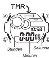
Der Countdowntimer kann auf eine Zeit im Bereich von einer Minute bis 24 Stunden eingestellt werden. Wenn der Countdown Null erreicht, ertönt ein Alarm. Der Countdowntimer besitzt auch eine Wiederholautomatik und einen Ablaufpieper, der den Ablauf des Countdowns signalisiert.
