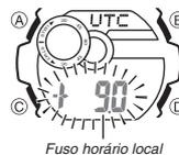
1. No modo de indicação das horas, pressione (A) até que os dígitos dos segundos comecem a piscar, o que indica a tela de definição.
