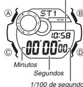
O seu relógio possui dois modos de cronômetro: modo do cronômetro (ST1) e modo do cronômetro (ST2). Ambos os modos de cronômetro permitem-lhe cronometrar o tempo decorrido, tempos intermediários, e os tempos dos dois primeiros colocados. O modo do cronômetro (ST1) inclui uma função de início automático.
