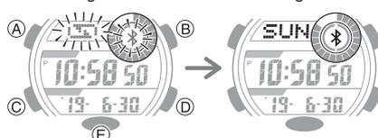
3. Führen Sie die auf dem Telefon angezeigte Aktion durch, um von der Uhr gemessene Daten an das Telefon zu übertragen.
