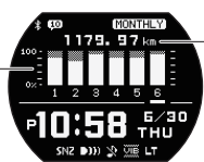
Avanzamento verso l'obiettivo mensile (distanza percorsa di corsa o tempo di percorrenza)
