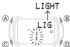
4. Pressione (D) para alternar entre as duas configurações de duração da iluminação.
