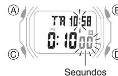
7. Use (B) e (D) para alterar o ajuste de segundos.
