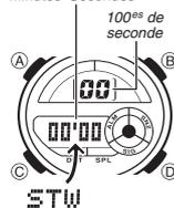
Le chronomètre permet de mesurer le temps écoulé, des temps partiels et deux arrivées.
