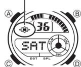
Une DEL (diode électroluminescente) éclaire l'afficheur pour qu'il soit mieux visible à l'obscurité. L'autocommutateur de la montre s'active et l'afficheur s'éclaire automatiquement lorsque vous orientez la montre vers votre visage.
