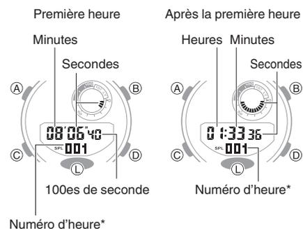
\* [F] s'affiche pour le numéro d'heure final lorsqu'une opération de mesure de temps écoulé est terminée.
