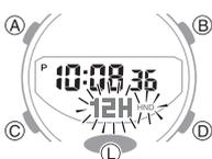
3. Premere (D) per passare da [12H] (formato di indicazione dell'ora a 12 ore) a [24H] (formato di indicazione dell'ora a 24 ore) e viceversa.
