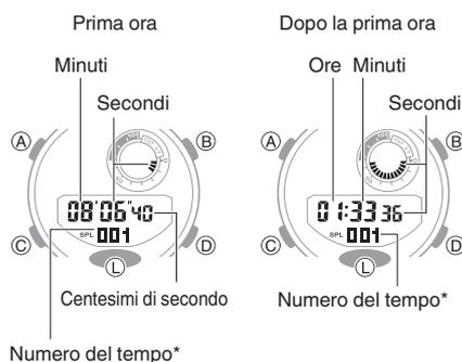
\* Viene visualizzato [F] per il numero del tempo finale quando si arresta l'operazione di misurazione del tempo trascorso.
