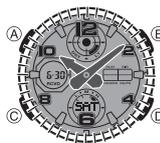
L'illuminazione facilita la lettura delle indicazioni al buio. La funzione di illuminazione automatica dell'orologio fa accendere automaticamente l'illuminazione quando si orienta l'orologio verso il proprio viso.
