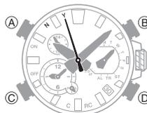
3. Lösen Sie die Krone innerhalb von 10 Sekunden, nachdem Sie die Aktion in Schritt 2 durchgeführt haben, und ziehen Sie sie anschließend auf die erste Raststellung heraus.
