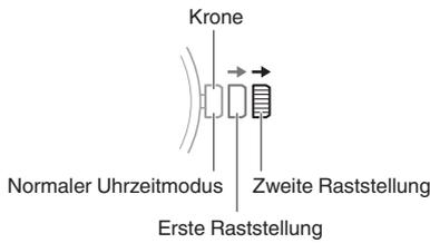
Drehen Sie die Krone nach dem Herausziehen bis zum ersten oder zweiten Klick mehrmals kurz in eine Richtung, um jeweils einen schnellen Vor- oder Rücklauf zu starten. Wenn ein schneller Vorlauf ausgeführt wird und Sie die Krone weiter schnell drehen, wird die Geschwindigkeit des Vorlaufs erhöht.
