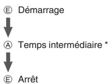
\* Chaque pression sur le bouton (A) affiche pendant environ huit secondes le temps écoulé (temps par tour) depuis la dernière opération de mesure du temps par tour. Le temps par tour est affiché pendant environ huit secondes, suivi du temps écoulé (temps intermédiaire).
