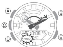
2. Pour replacer les aiguilles dans leurs positions d'indication de l'heure normale, maintenez le bouton (B) enfoncé tout en appuyant de nouveau sur le bouton (D) ou appuyez sur le bouton (D) pour basculer vers un autre mode.
