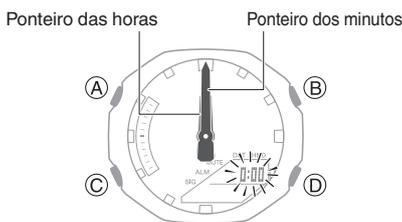
3. Se o ponteiro das horas e o ponteiro dos minutos não estiverem na posição de 12 horas, use (B) e (D) para alinhá-los.
