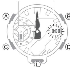
5. Se le lancette delle ore e dei minuti non sono sulle ore 12, utilizzare (B) e (D) per allinearle.
