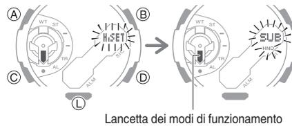
3. Se la lancetta dei modi di funzionamento non è allineata con l'indicazione delle 6, utilizzare (B) e (D) per allinearla.
