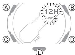
4. Premere (B) o (D) per selezionare [12H] (indicazione dell'ora a 12 ore) o [24H] (indicazione dell'ora a 24 ore).
